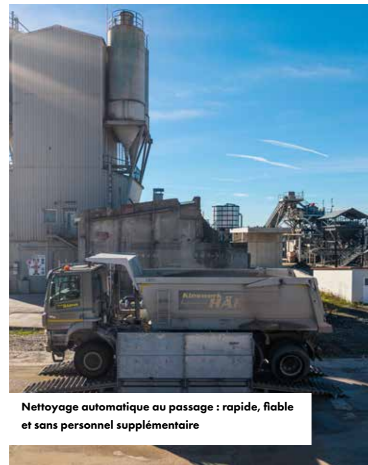
Le système de lavage de pneus réduit efficacement le transport de saleté vers les voies publiques
