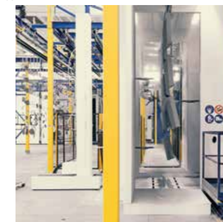
➤ Cabines automatiques de peinture poudre en PVC avec cyclone pour changement de couleur rapide
