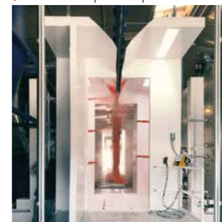
➤ Cabines automatiques de peinture poudre en PVC avec cyclone pour changement de couleur rapide
