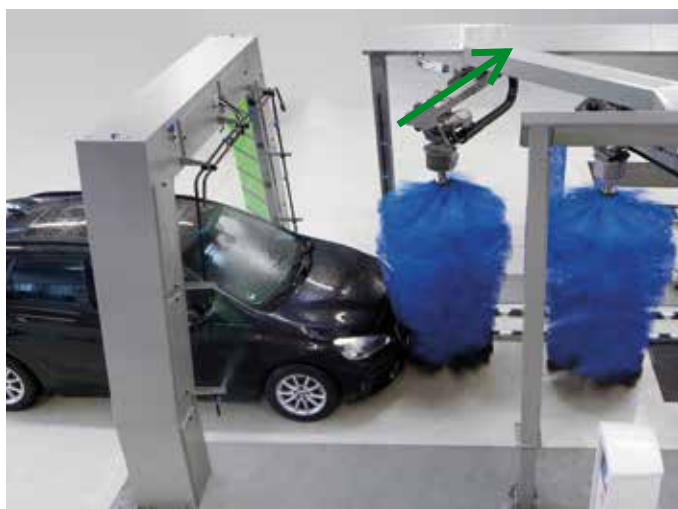
Lavage avant d'accompagnement de la brosse latérale de gauche (flèche verte)
