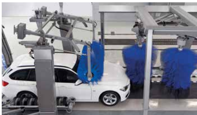
Lancement du processus de lavage sur l'EVO-4. Le véhicule est poussé contre la brosse latérale gauche pivotante.
