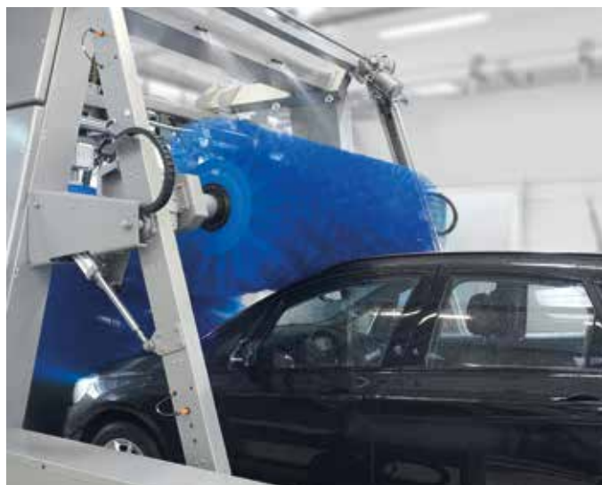
La brosse horizontale accompagne le mouvement en haut et monte à l'avant.
