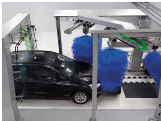
Lavage latéral à gauche, lavage avant de la brosse de droite (flèche verte)
