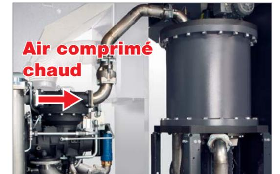
**Séchage de l'air comprimé par adsorption**
